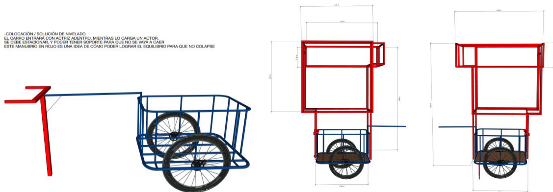
Imagen 24. Diseño de la intervención del remolque de bicicleta para la realización del carromato, creado por el escenógrafo Edgar Mora para la obra Tambache de Cachivaches . Ilustración: Edgar Mora.
